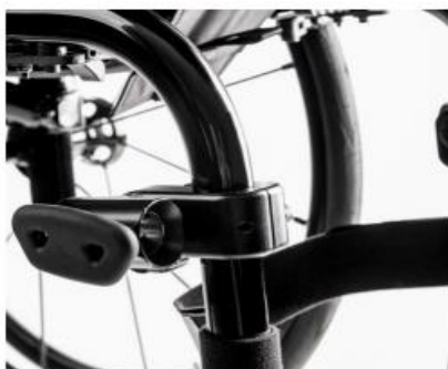
EMD010029: Colliers de fixation pour fauteuils roulants avec tubes de cadre ronds (pour diamètres de tube 19,5 / 23 / 25 / 28,6 / 30 mm).
