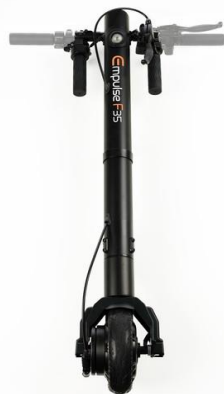
EMD090207: Poignées rabattables avec blocage en position repliée.
