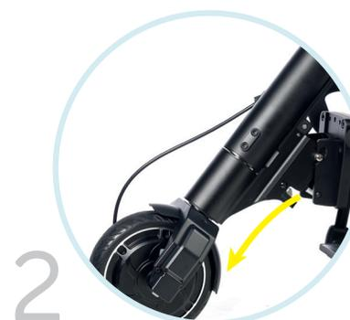
2. Baixe lentamente a handbike até que as rodas da cadeira toquem no solo. Se pretender remover a estrutura inferior, siga os passos 3 e 4.
