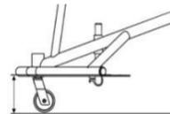
Distance entre le repose-pieds et le support de roue avant (espace entre l'arrière du connecteur Caster et le bord avant de la palette)
