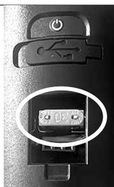
**Pour remettre le fusible en place, insérez le fusible et refermez le cache en caoutchouc.**
