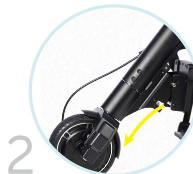
2 Senken Sie nun das Zuggerät ab, bis die Lenkräder des Rollstuhls den Boden berühren. Um das F35 nur vom Zwischenrahmen abzunehmen, können die Schritte 1 und 2 unabhängig von den Schritten 3 und 4 durchgeführt werden.
