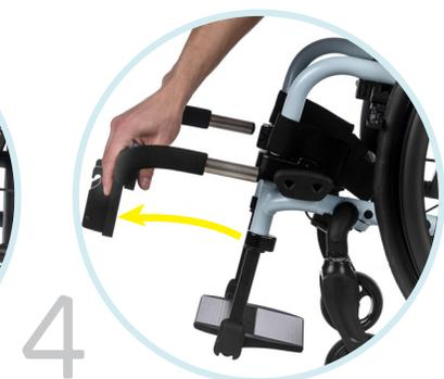
4 Entfernen Sie den Zwischenrahmen aus den Andockklappen.
