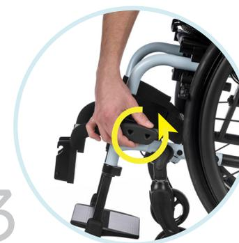
3 Lösen Sie die Knebelschrauben der Klemmen auf beiden Seiten und ziehen Sie den Zwischenrahmen ab, bis die Rohre des Zwischenrahmens vollständig aus den Klemmen herausgezogen sind.
