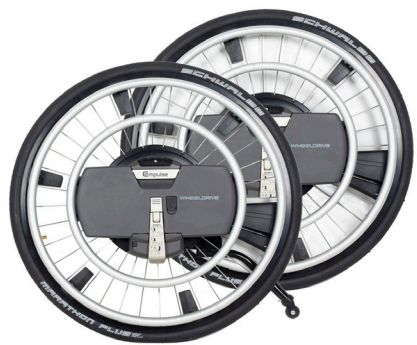
Empulse WheelDrive Drivhjul med elektrisk motor.
