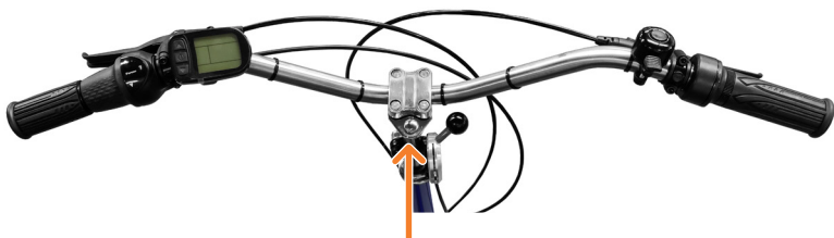
Figur 4: Løsne bolten med en umbrakonøkkel
