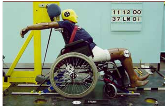
Après l'impact - fauteuil roulant arrimé aux rails.
