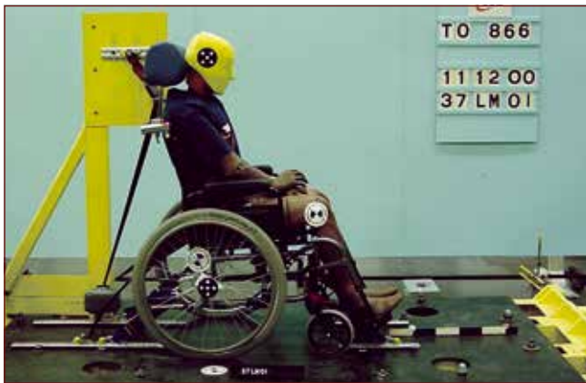
Avant l'impact - fauteuil roulant arrimé aux rails.
