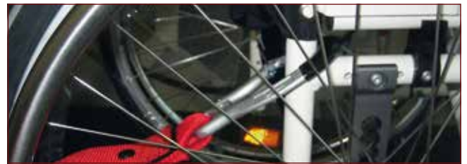
Point d'arrimage sur le fauteuil roulant (arrière)
