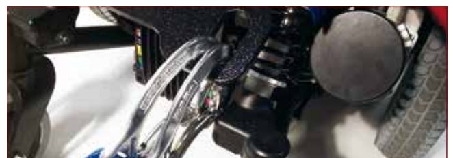
Point d'arrimage sur le fauteuil roulant électrique (arrière)
