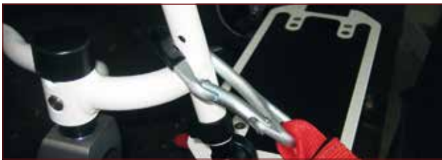
Point d'arrimage sur le fauteuil roulant (avant)
