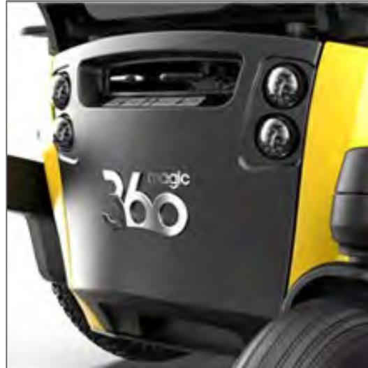
Eclairage arrière montés sur le capot arrière
