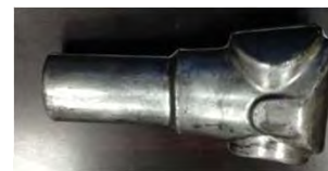
Pièce de dossier fixe à 90° juste après l'opération de pressage
