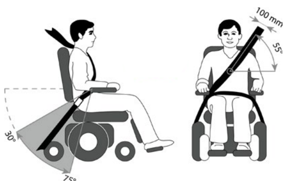
Fig. 3: Angle de fixation de la ceinture pelvienne
