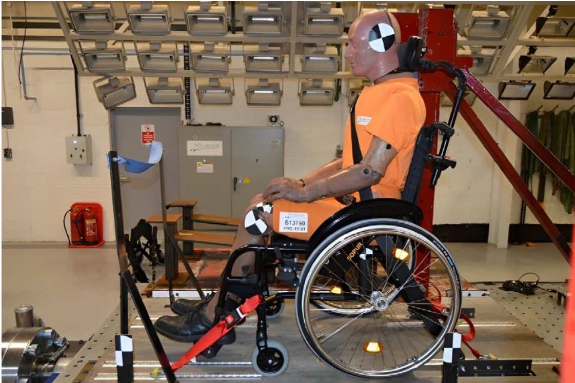
Fauteuil roulant arrimé aux rails, avant l'impact
