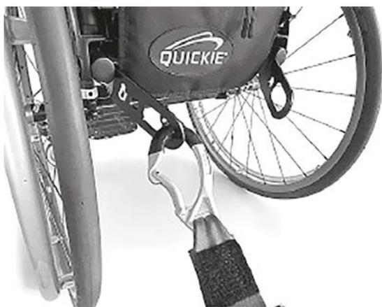
Position du système de retenue à l'arrière
