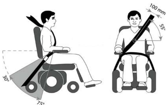
Fig. 3: Angle de fixation de la ceinture pelvienne
