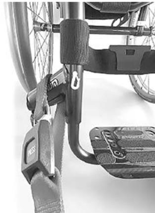
Position du système de retenue à l'avant
