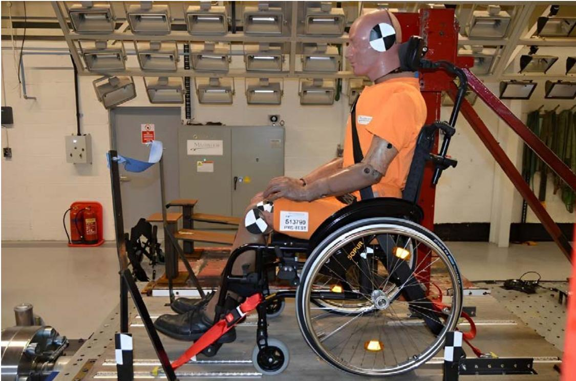
Fauteuil roulant arrimé aux rails, avant l'impact
