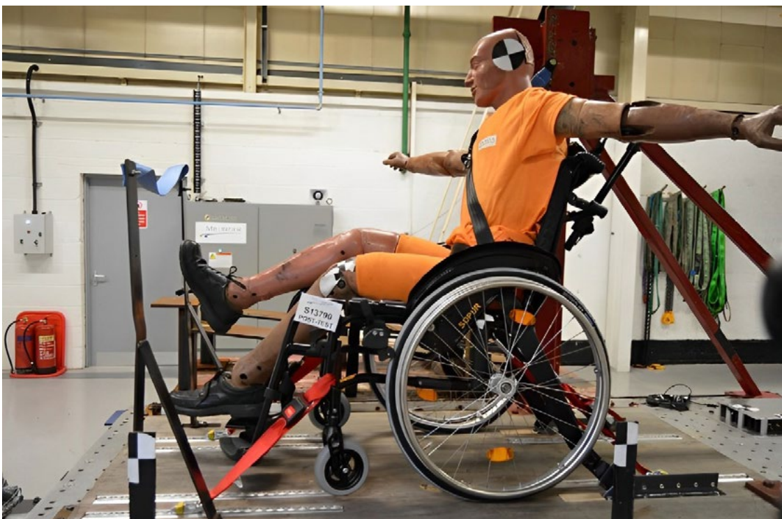
Fauteuil roulant arrimé aux rails, après l'impact
