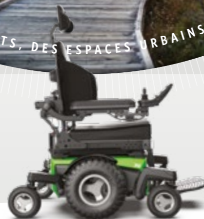
Crossover - roues motrices 14" suspension et confort optimum (largeur base motrice 635 mm)
