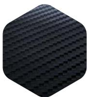
**LE CARBONE** a des propriétés d'absorption des vibrations atténuant les effets provoqués par les surfaces irrégulières. L'un des avantages principaux du carbone est son rapport solidité / poids. Alors qu'il est ultraléger, il est en même temps extrêmement solide, ce qui signifie que la transmission de l'énergie d'entraînement est hautement efficace et permet une conduite douce mais précise.
