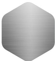
**L'ALUMINIUM** permet une conduite plus directe et plus efficace et est utilisé de préférence lorsque la performance est plus importante que le confort. Il est souvent apprécié pour sa polyvalence et représente aussi l'un des meilleurs matériaux pour la fabrication de fauteuils roulants haut de gamme. RGK n'utilise que du A7020, le meilleur des types d'aluminium, et procède pour certains modèles à un traitement thermique spécial pour réduire son poids.
