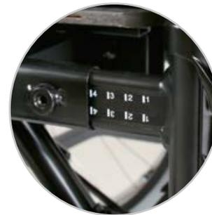
Il est simple et rapide d'adapter le fauteuil à l'utilisateur grâce à la graduation intégrée.
