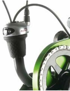
// ATT070043 Commutateur à poignée tournante monté sur le cadre
