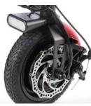
// Éclairage LED, garde-boue et frein à disque (représenté avec roue motrice 8,5" EMF070085, pneu plein)
