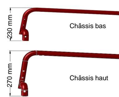
Hauteur du siège arrière en mm
