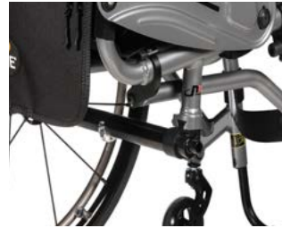
// NTR010402 Tube de l'axe, carbone, rouge // NTR100562 Couleur du moyeu, rouge
