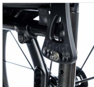
// QSC030012 Rücken, winkeleinstellbar, nicht abklappbar (75° - 105°)
