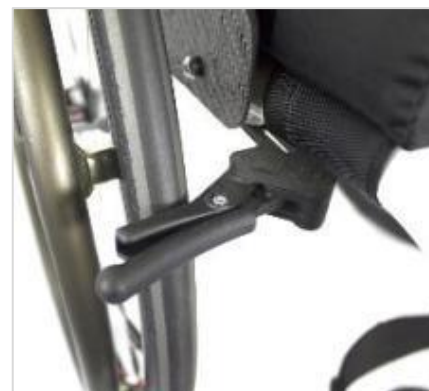
XD035 - 軽量固定式コンパクトシ ザーブレーキ (固定式車軸のみ)
