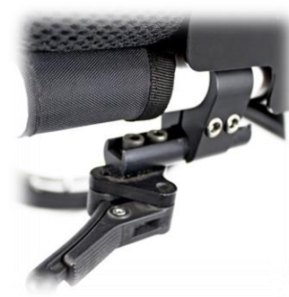
コンパクトブレーキ 車椅子操作の邪魔にならないが ロックに手指の強い力が必要
