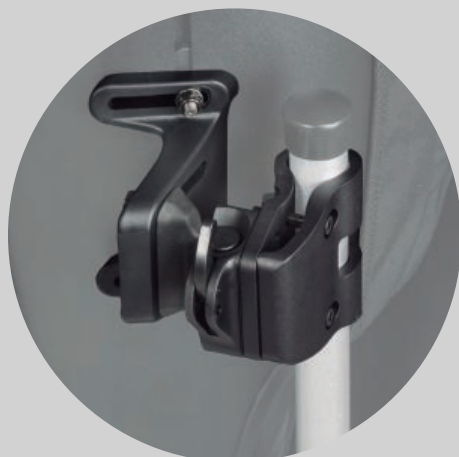
二点留めクイックリリース式取付金具(TH) J3バックを差し込むとワンタッチでロックされて外れません。外す際はピンを倒せばロックが解除されて簡単に取り外せます。 写真はティルト用取付金具(TH)
