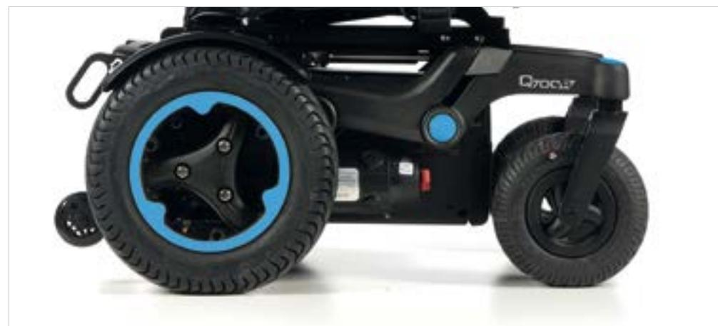
すべてのQ700ベースは、パワフルな4ポール トルクモーターを使用し、最高の快適性とけん引力のフルホイールサスペンションを組み合わせた究極のアウトドア性能を提供します。大きなホイールが障がい物を軽々と乗り越え、80Ahの大容量バッテリーが安定した走りを可能にします。
