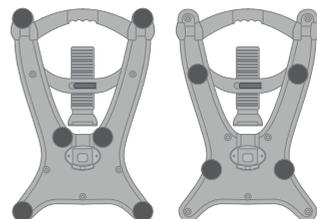
Die GummifüÙe sind verstellbar und können sich der Form der Badewanne anpassen. Sie verstellen die GummifüÙe, indem Sie diese, entsprechend der gewünschten Einstellung, entweder im oder gegen den Uhrzeigersinn drehen.
