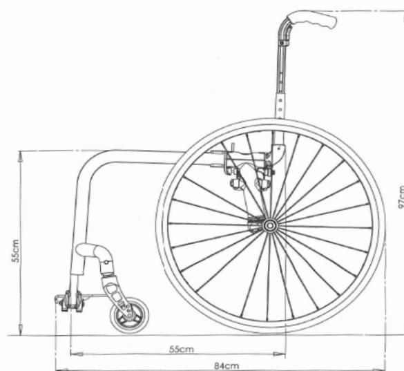
Abbildung: Masse bei Sitztiefe 400 mm und 24" Antriebsräder
