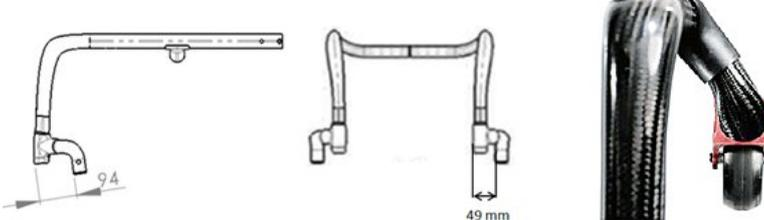
Schmalere (-24 mm pro Seite), nach hinten gerichtete (+22 mm) Position der Lenkräder für kompaktere Abmessungen und verbesserte Manövrierfähigkeit. Geringere Frontstabilität ggü. Lenkradanbindung weit.
