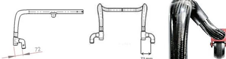
Breitere, nach vorne gerichtete Position der Lenkräder für minimierten Rollwiderstand und höhere Frontstabilität.
