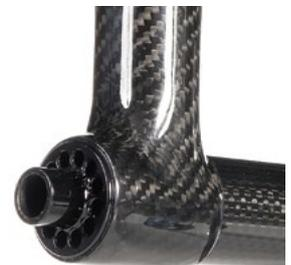
// **Sturzadapter superlight (KRR070049):** (nur 0° Sturz): direkt ins Achsrohr eingeklebt, keine Einstellbarkeit der Spurweite möglich (-160 g im Vergleich zum verstellbaren Sturzadapter)
