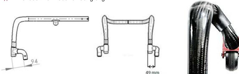
Schmalere (-24 mm pro Seite), nach hinten gerichtete (+22 mm) Position der Lenkräder für kompaktere Abmessungen und verbesserte Manövrierfähigkeit. Geringere Frontstabilität ggü. Lenkradanbindung weit.
