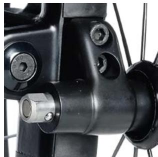
// **Achsaufnahme, Leichtgewicht (KRF070701):** (nur 0° Sturz) (-260 g im Vergleich zur Achsaufnahme Standard)
