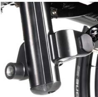
// **Achsadapter, gekürzt (KRF010412):** genau auf die gewünschte Sitzhöhe abgelängt (nur noch +10 mm Sitzhöhereinstellung möglich) (durchschnittl. -200 g im Vergleich zum langen Achsadapter, Gewichtsersparnis abhängig von der Sitzhöhe)
