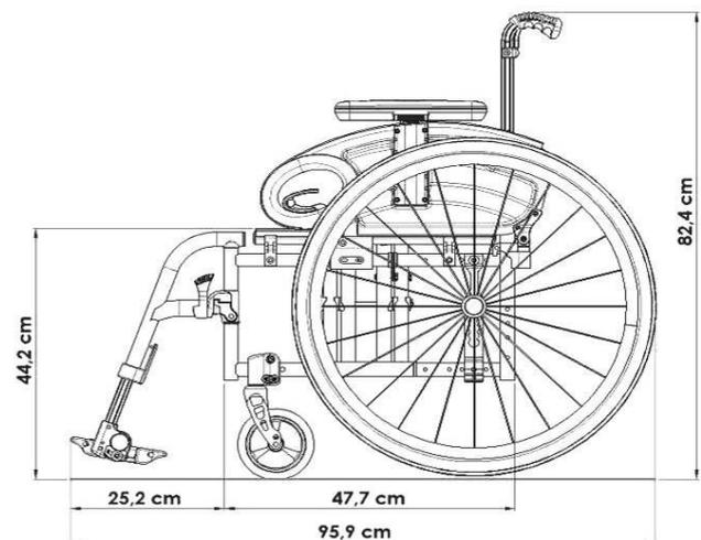
Abbildung: Masse bei Sitztiefe 400 mm und 24" Antriebsräder
