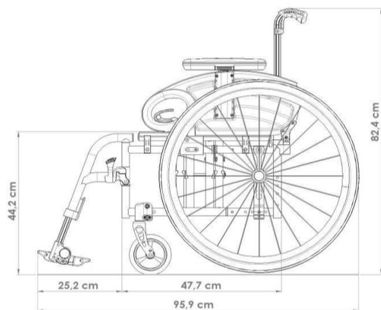
Abbildung: Masse bei Sitztiefe 400 mm und 24" Antriebsräder
