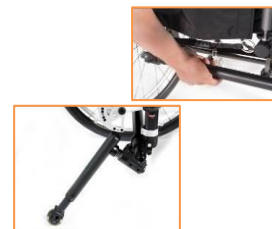
090008/090033 Sicherheitsrad abschw- und vom Nutzer bedienbar
