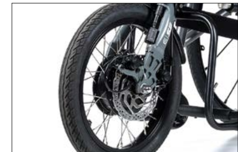
Triplebremssystem: Mechanische Doppelbremse und proportionale elektrische Motor- bremse.
