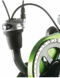
// ATT070043 Drehgriffschalter am Rahmen montiert
