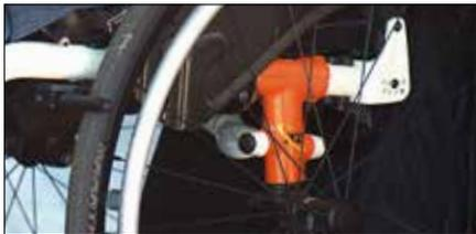
Mécanisme de réglage du centre de gravité.
