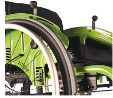
SIB040103 Protector de aluminio (en este caso con freno Safari)
