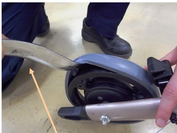
Nota: per facilitare le operazioni di rimozione o montaggio dello pneumatico servirsi di una spatola o di uno strumento simile.
