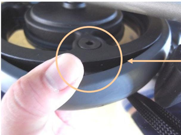
Le tre parti dello pneumatico sporgenti internamente devono essere inserite nelle tre tacche rientranti della ruota.
