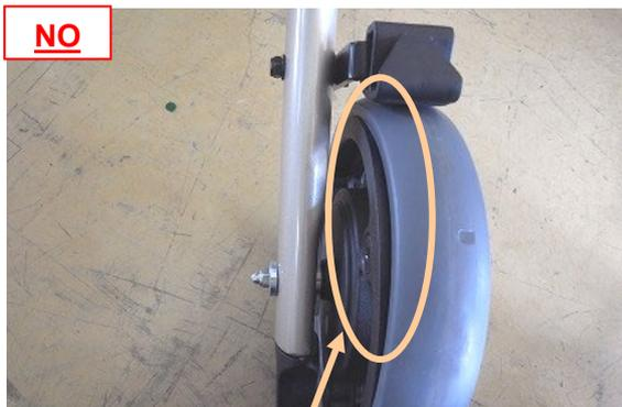
La parete laterale dello pneumatico non è correttamente allineata alla ruota.
