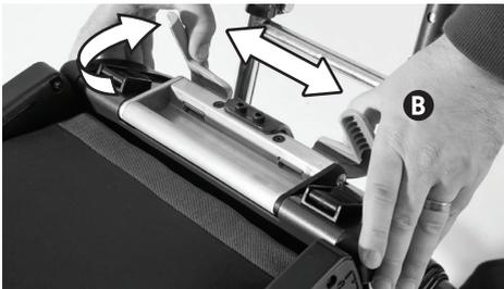
Posizionare la base dello schienale **C** nell'elemento ricettore accertandosi che sia completamente inserita. Per fissare in posizione lo schienale ruotare in basso le alette **D** e spingerle verso l'interno **E**.
