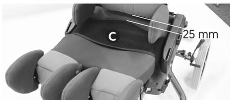
Posizionare la base con Velcro **D** della cintura pelvica Contour Cradle sulla fascia di fissaggio **C** e assicurarsi che il Velcro della cintura pelvica Contour Cradle non tocchi il rivestimento del cuscino della seduta. Fare scorrere la cinghia nera attraverso le fibbie a camma di entrambi i lati anteriori della seduta, **E**, e chiudere le fibbie a camma. Fare scorrere la cinghia grigia nelle fibbie a camma di entrambi i lati del retro della seduta **F** e chiudere le fibbie a camma.
