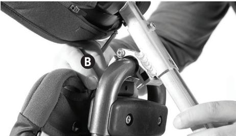
Serrare i componenti del morsetto accedendo alla testa del bullone attraverso il foro della superficie esterna della sporgenza **C** e inserire l'estremità finale del bullone nel foro dell'altra metà del morsetto e avvitarlo al dado. Il dado viene trattenuto all'interno della sporgenza e potrebbe essere necessario riallinearlo al foro. Serrare con la chiave a brugola.
