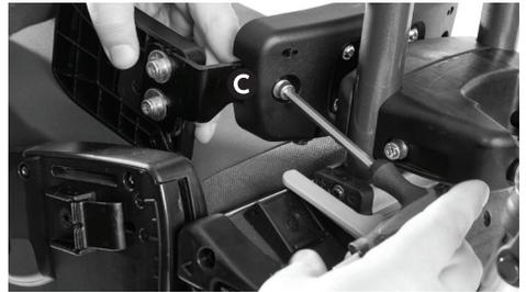
Posizionare la rondella aperta e, quindi, quella piatta sul bullone, inserirlo nel foro posteriore del supporto lombare **C** e avvitarlo al dado a "T". Fissare in posizione con la chiave a brugola.
