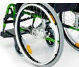
// BRS070068 Koła tylne, 24", pełne, hamulce bębnowe, 36 szprychowe (silver), szprychy krzyżowe, ciągi Alu anodowane,
