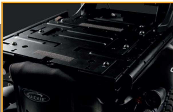
**Profundidade do assento** ajustável de 400-560 mm, duas placas diferentes disponíveis para a profundidade do assento (400-520 mm e 460-560 mm).
