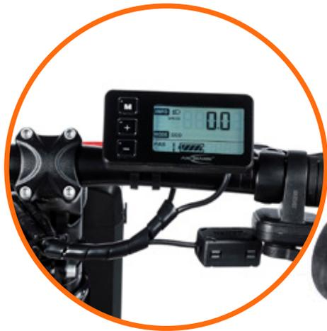
Configura o modo de velocidade ou ajusta a velocidade independentemente (por exemplo, aceleração mais lenta para pessoas com menor estabilidade de tronco)
