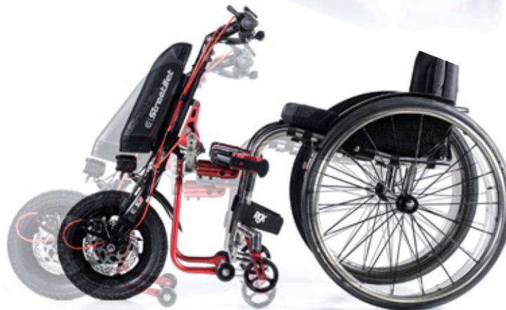
**2** Mantén apretada la palanca de liberación del manillar mientras empujas la StreetJet hacia delante y hacia arriba. Suelta la palanca de liberación para bloquear la posición.
