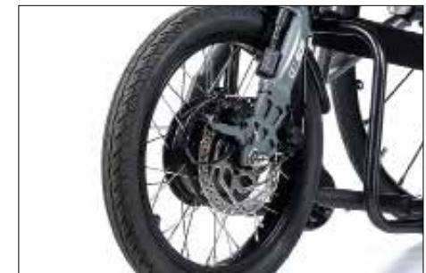
Système triple frein Double frein mécanique et électrofrein séparé.
