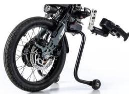
STE060025: Frein à disque mécanique Shimano
