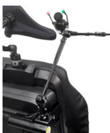
Allround Joystick en brazo abatible eléctrico
