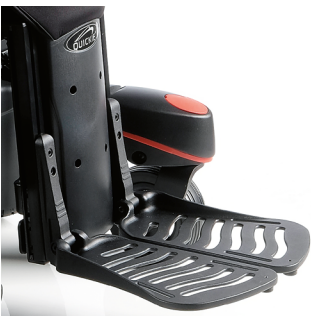
Reposapiés central elevable eléctrico // QUE050071
