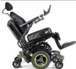
Módulo de Elevação e Basculação elétrica
