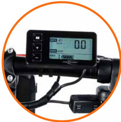
Einstellung des Maximalgeschwindigkeitsmodus, sowie der Beschleunigung (z.B. langsamere Beschleunigung für Personen mit geringerer Rumpfstabilität).
