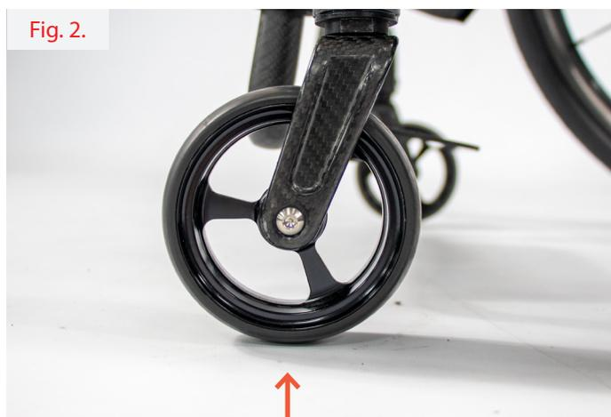
Roues avant orientées vers l'arrière
