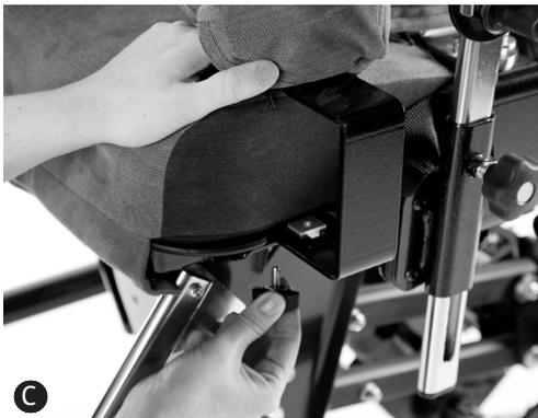
Bei Größe 3 richten Sie die Halterung der Abduktionspelotte auf den Schlitz vorne an der Sitzbasis aus, wenn der Sitz auf die maximale Tiefe eingestellt ist. Schieben Sie die Halterung in die gewünschte Position, setzen Sie die Schraube ein und ziehen Sie sie fest an **C**.
