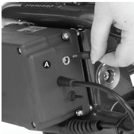
Antes de ponerlo en funcionamiento, asegúrese de que el cable del mando no quede atrapado o enrollado en ninguna de las partes del chasis.
