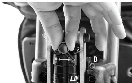
Para aumentar la presión de aire, bombee aire en la válvula, hasta la presión deseada. Para disminuir la presión, presione la válvula de descarga de aire en la bomba hasta alcanzar la presión deseada.
