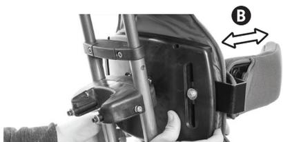
Puede que sea necesario aflojar los tornillos de ajuste del ángulo para lograr el ajuste de la profundidad, según 18.11. Asegúrese de que ambos juegos de tornillos estén apretados para asegurar su posición después del ajuste.
