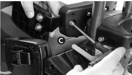
Coloque la arandela partida y luego la arandela plana en el tornillo y páselo a través del orificio de la parte posterior de la moldura sacra **C**; enganche las roscas de la tuerca en T. Asegure las fijaciones en su sitio con la llave Allen.
