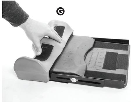
También puede ajustar la profundidad de la placa base para evitar que sobresalga la placa de asiento contorneada. Para ajustar la profundidad del asiento en la placa del asiento, afloje los tornillos izquierdo y derecho situados en la parte inferior de la base del asiento, y desplace la base hacia delante y hacia atrás hasta lograr una posición adecuada. Apriete ambos tornillos para fijarlos en su sitio (véanse las imágenes 18.1 ó 18.2).
