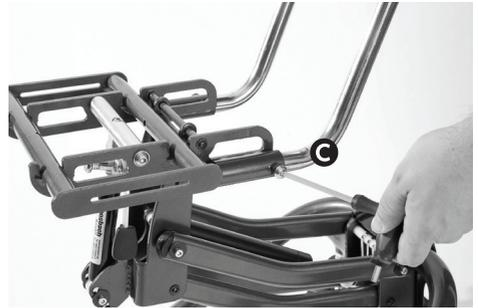
Para retirar el manillar, invierta el paso **C**, luego presione los topes de seguridad **D**, y saque los tubos del manillar de los vástagos inferiores.
