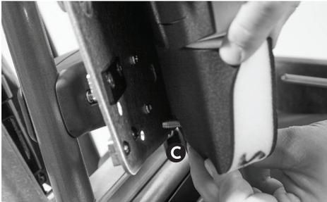
Com a chave de bocas, aperte todos os quatro parafusos com uma porca **D**, de modo a que a extremidade dos parafusos fique rente à extremidade da porca **E**.
