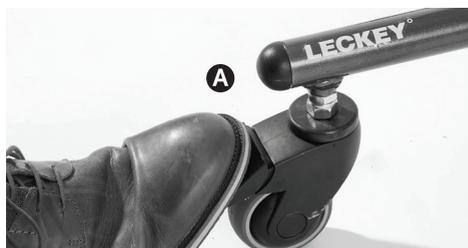
Para acionar os travões num chassis para interiores/exteriores ou chassis "HIGH-LOW" grande, empurre a alavanca de travão manual **B**, na parte dianteira da roda traseira. Para soltar, puxe a alavanca para cima. O chassis para interiores/exteriores ou chassis "HIGH-LOW" grande não está equipado com travões na roda dianteira.
