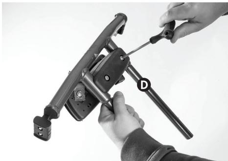
Coloque as extremidades da barra do encosto nos recetores no gancho de altura do encosto. Pressione as molas **E**, nos lados e empurre a barra do encosto ainda mais para baixo. Aperte os parafusos no gancho de ajustamento da altura do encosto **F**.
