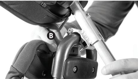
Aperte, segurando na cabeça do parafuso através do furo na superfície exterior da extrusão **C**, e colocando e enfiando a extremidade do parafuso no furo na outra metade do gancho, encaixando nas roscas da porca. A porca é fixada na extrusão e poderá ser necessário realinhá-la com o furo. Aperte com a chave Allen.
