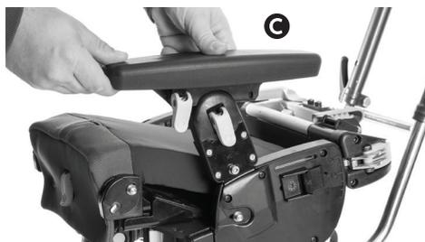
Para remover o apoio para o braço, faça deslizar o botão de libertação para a frente do assento **D**, e puxe o apoio para o braço para fora da ranhura **E**.
