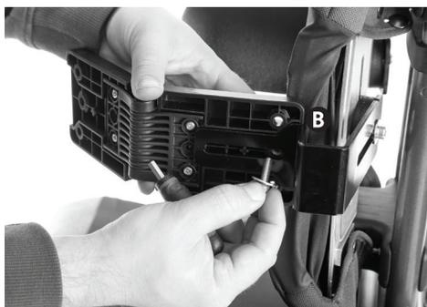
Coloque a anilha dividida, depois a anilha plana no parafusos e passe-o pelo furo do molde **C**, encaixando nas roscas da porca. Fixe com a chave Allen.
