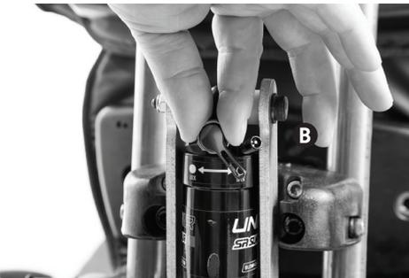
Para aumentar a pressão, bombeie ar para a válvula até atingir a pressão pretendida. Para reduzir a pressão, pressione a válvula de libertação de ar da bomba até atingir a pressão pretendida.
