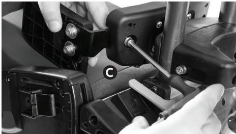
Coloque a anilha dividida, depois a anilha plana no parafusos e passe-o pelo furo na parte traseira do molde sacral **C**, encaixando nas roscas da porca. Fixe com a chave Allen.
