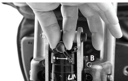
Para aumentar a pressão, bombeie ar para a válvula até atingir a pressão pretendida. Para reduzir a pressão, pressione a válvula de libertação de ar da bomba até atingir a pressão pretendida.
