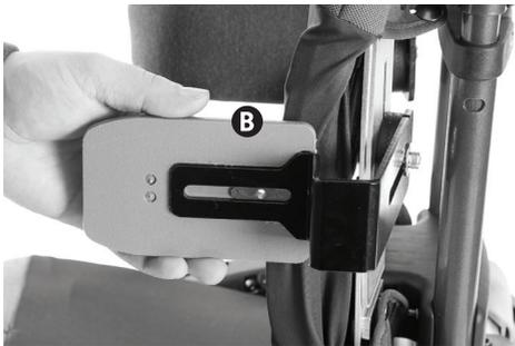
Coloque a anilha dividida, e depois a anilha plana no parafuso e enfie-o no furo roscado na peça maquinada **C**. Fixe com a chave Allen.
