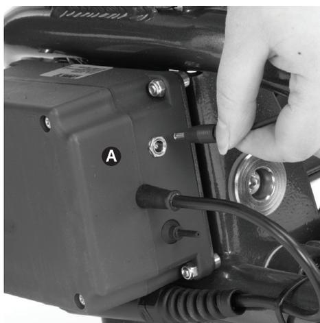
Antes de utilizar a cadeira, certifique-se de que o cabo para o comando manual não está preso ou enrolado em qualquer parte do chassis.
