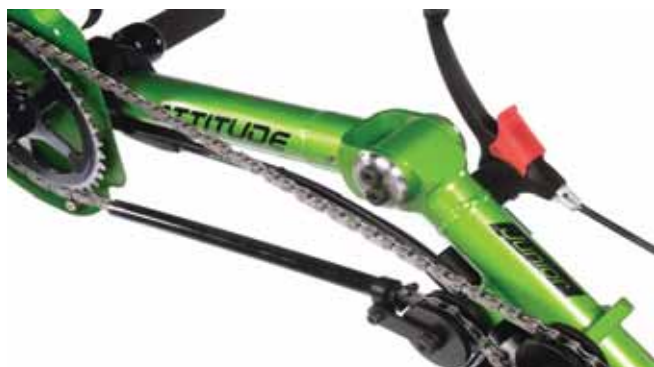
Fourche pour Attitude Junior, pédalier réglable en angle et en profondeur
